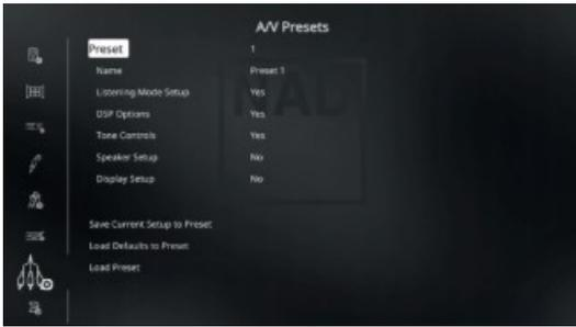
Le système simple et puissant des "A/V Presets" du T 758 vous permet de personnaliser pratiquement tous les aspects de la lecture audio-vidéo, et de rappeler ces configurations personnalisées en appuyant sur une simple touche. Les paramètres «DSP Options» et «Tone Controls» accessibles via le «Main Menu» avec «Listening Mode Setup», «Speaker Setup» et «Display Setup» configurables via «Setup Menu» sont stockés ensemble sous la forme d'un seul A / V Preset (préréglé).
