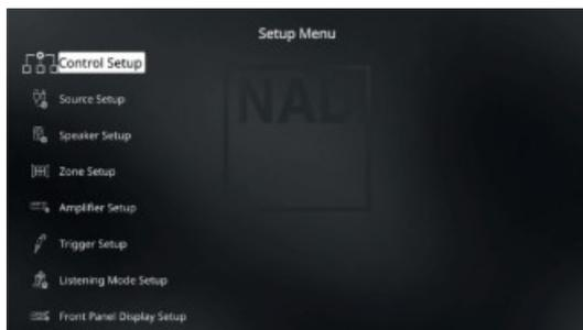
Le Menu de Configuration vous permet de personnaliser le fonctionnement du T 758 en fonction des appareils auxiliaires dont vous disposez sur votre chaîne A/V. Si votre chaîne ne correspond pas exactement à la configuration par défaut indiquée dans le Guide de Mise en Marche Rapide fourni, il vous sera nécessaire d'utiliser le menu de configuration pour configurer les entrées du T 758.
