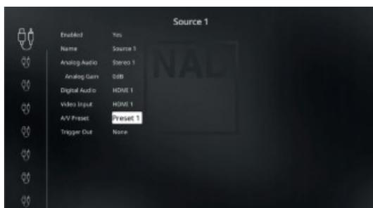
Dans l'exemple ci-dessus, les paramètres "Preset 1" sont attribués à Source 1. Chaque fois que la Source 1 est accédée, les paramètres "Preset 1" seront appliqués à Source 1. Vous pouvez toujours remplacer manuellement l'allocation Preset A / V assignée dans un Source avec un autre paramètre / numéro de préréglage en appuyant sur les touches de la télécommande appropriées.
