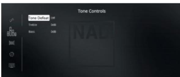
Le T 758 comporte deux niveaux de Commande de la Tonalité – « Treble » (Aigus) et « Bass » (Graves). Les commandes des Graves et des Aigus n'affectent que les fréquences graves les plus basses et les fréquences aiguës les plus hautes, de manière à ne pas affecter les fréquences de la plage centrale critique.
