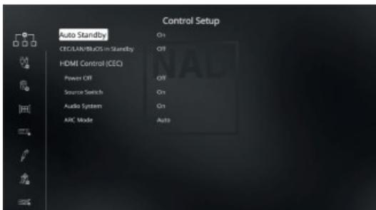
Le T 758 prend en charge les fonctions HDMI Control (CEC) et Audio Return Channel (ARC). Les deux fonctions sont possibles si des périphériques externes prenant en charge les deux fonctions sont interconnectés avec le T 758 via une connexion HDMI.
